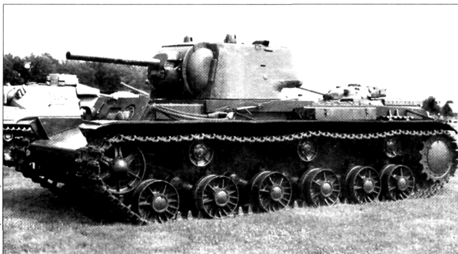
Танк KV-1 с литой башней производства УЗТМ и дополнительным бронированием корпуса. Именно эта машина проходила испытания на Абердинском полигоне в США в 1942 году
