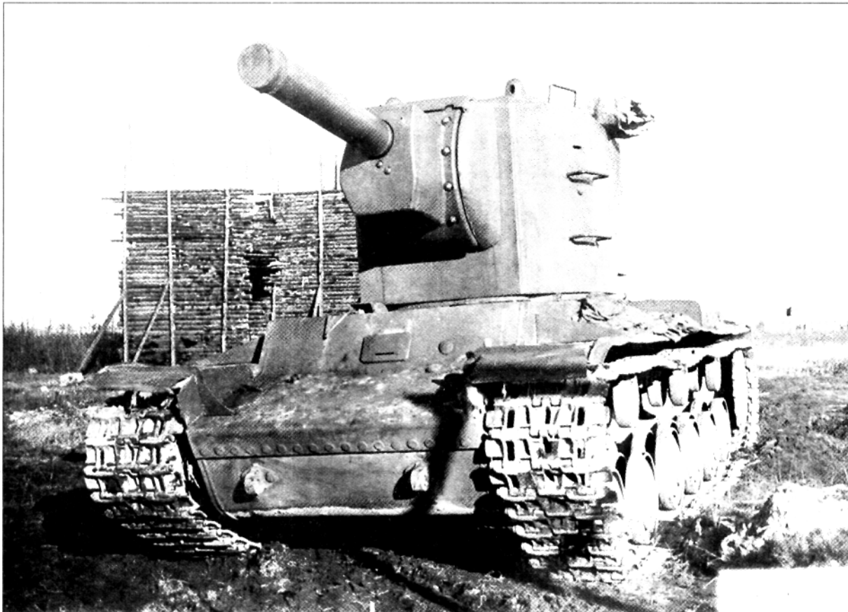
Танк У-7 с первым образцом «пониженной» башни перед испытаниями. Сентябрь 1940 года
