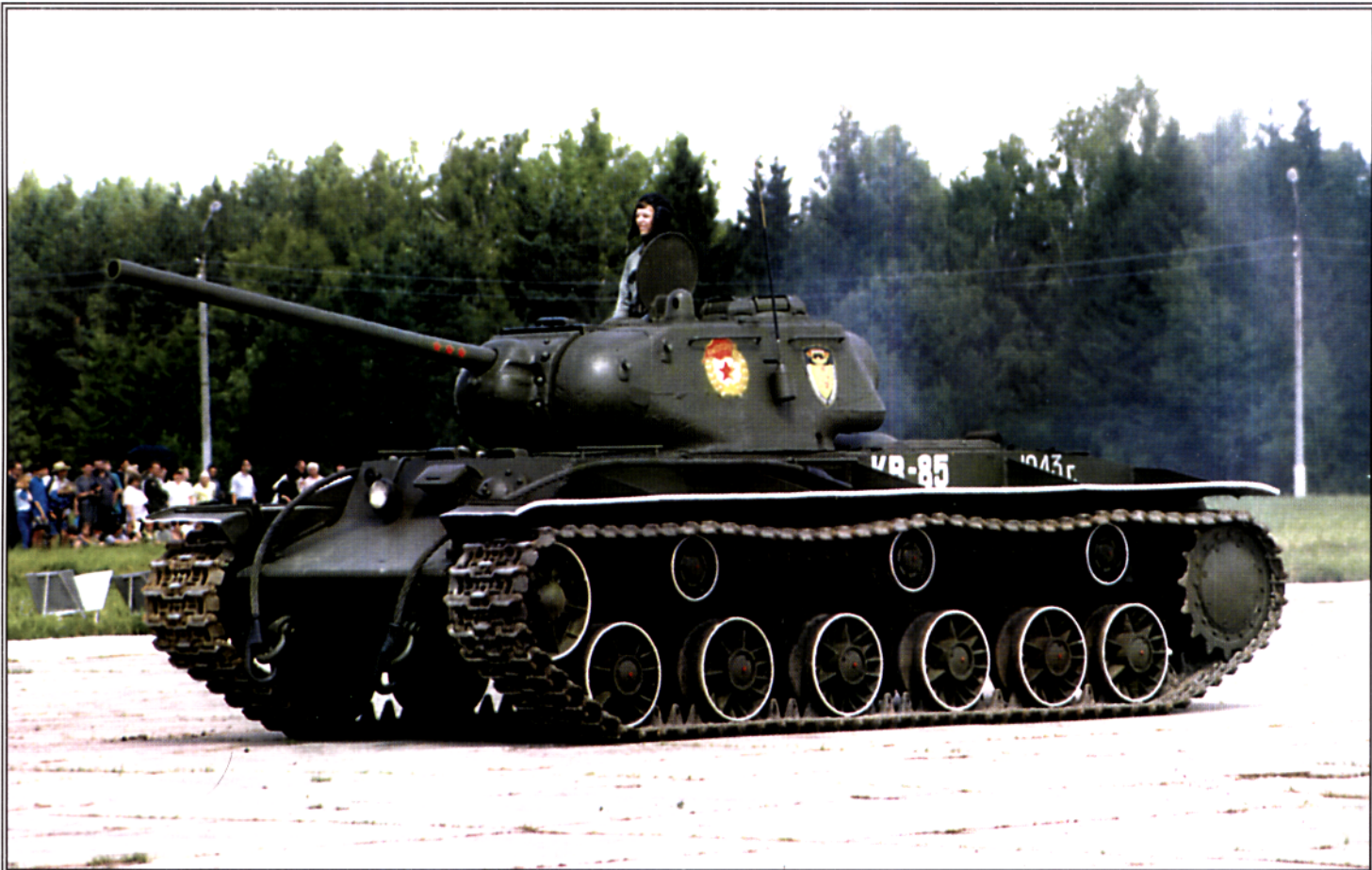
Тяжелый танк объект 238 (КВ-1С с 85-мм пушкой С-31). Кубинка, 2001 г.
