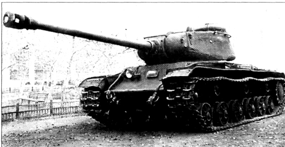
КВ-122 — танк КВ-85 с башней ИС-122. Челябинский Кировский завод, осень 1943 года
