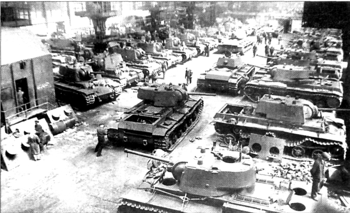
Сборочный цех Челябинского Кировского завода, весна 1942 года. Хорошо видно, что в процессе сборки находятся танки как с литыми башнями, так и со сварными упрощенной формы. Большинство машин имеет также и упрощенную кормовую часть корпуса
